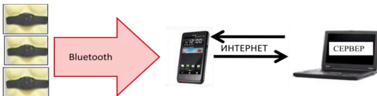
Рис. 7. Схема беспроводной регистрации кардиосигнала.
